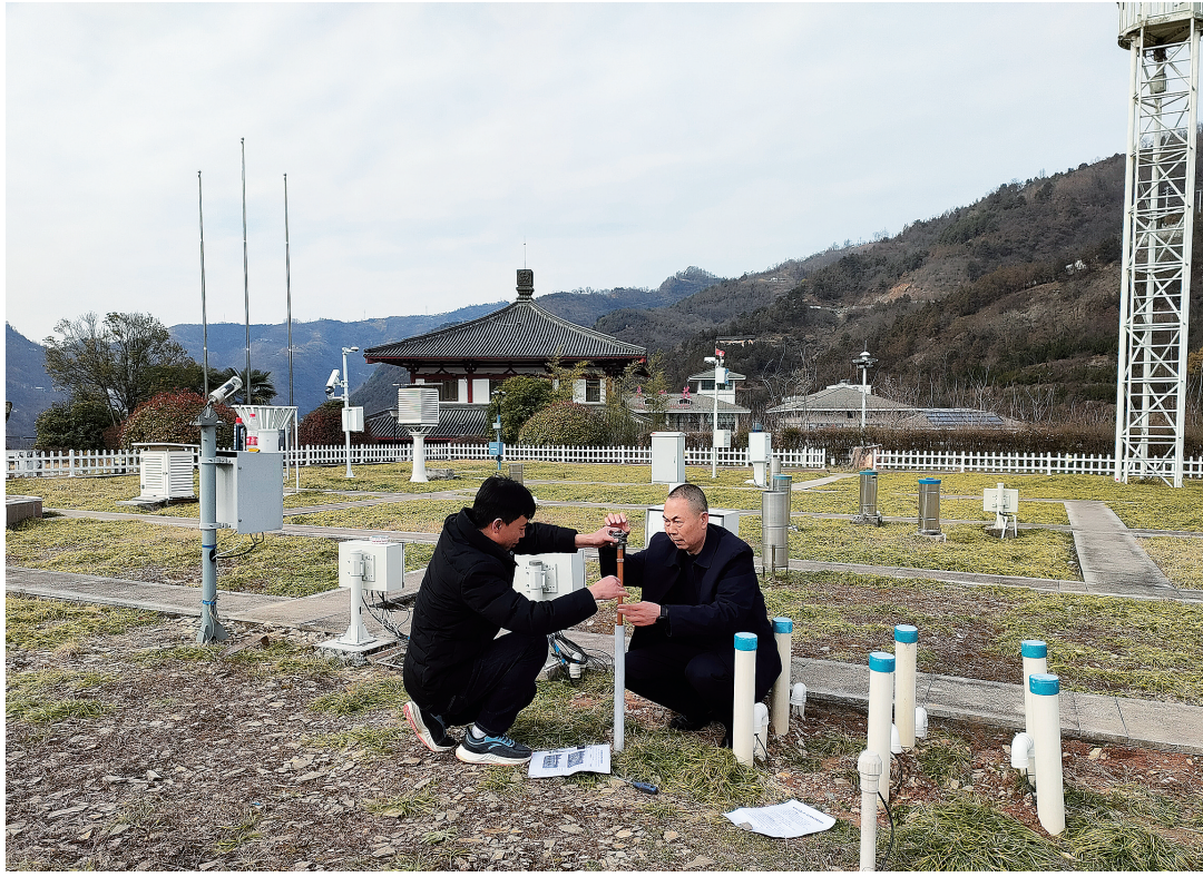
1月22日,镇安县气象局技术保障人员对国家基本气象站气象监测设备开展维护巡查,加强固态降水测量设备、自动冻土观测仪、不同下垫面温度测量等现代监测手段应用,充分发挥精密监测效益,为冬季低温雨雪冰冻天气气象服务保障做好观测支撑。(本报通讯员 蔡江萍 摄)
