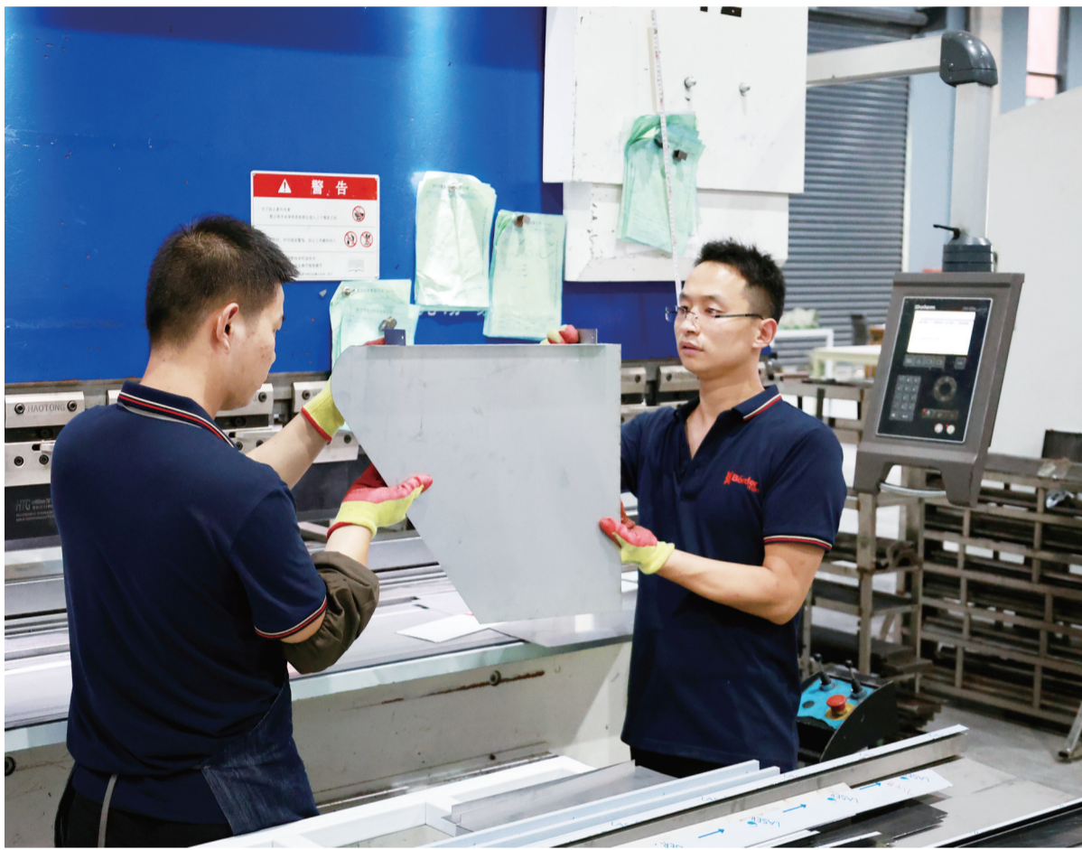
8月5日,位于柞水现代装备制造产业园的陕西博德曼科技有限公司二期厂房,工人正在检查不锈钢部件。据悉,该企业主要生产各类不锈钢制品,包含不锈钢产品的冲剪、折弯、成型和表面处理,年生产各类不锈钢制品16万平方米,年产值可达2亿元,新增就业岗位60多个。(本报记者 谢非 摄)
