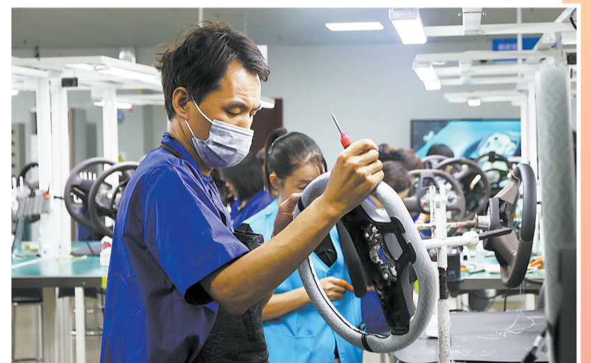
在商洛比亚迪生产车间，工人正在组装汽车方向盘。
